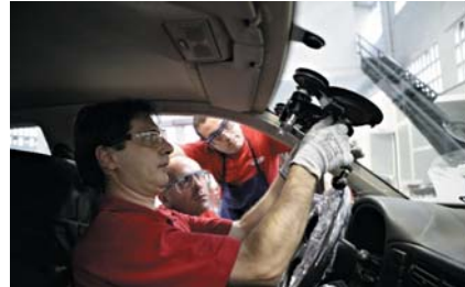
Fig. 5.4. Secuencia de imágenes correspondientes al proceso de sustitución de un parabrisas.
