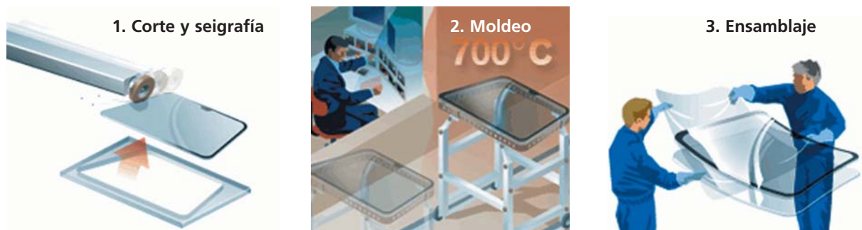
Fig. 1.9. Secuencia de fabricación del cristal laminado 8
