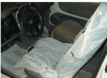
Fig. 5.1. Protecciones en el proceso de reparación.
