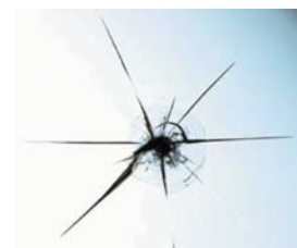
Rotura con grietas
