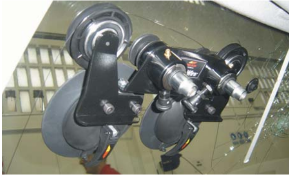
Fig. 5.3. Herramientas empleadas por Carglass® en el procedimiento de sustitución de un parabrisas.
