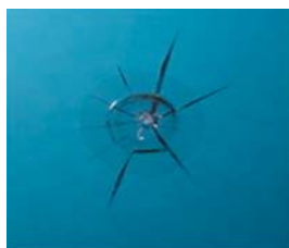
Ojo de buey con micro-fisuras
