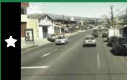
Una sola dirección con fricción lateral y obstáculos en los laterales
