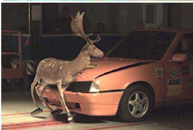
25ms: El cuerpo del ciervo golpea contra el capó y causa deformaciones en la parte delantera.
