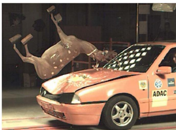
230ms: El ciervo sigue desplazándose con casi la misma velocidad, el vehículo desacelera con bastante fuerza. Por ello el ciervo y el vehículo se separan.
