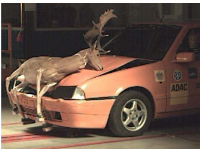
55ms: El ciervo pierde contacto con el suelo y se apoya completamente contra el capó. El capó muestra fuertes deformaciones en la parte anterior y posterior.
