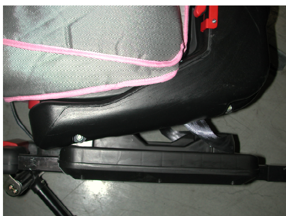
Figura 13: IWH Megamax - montado solamente en el anclaje delantero
