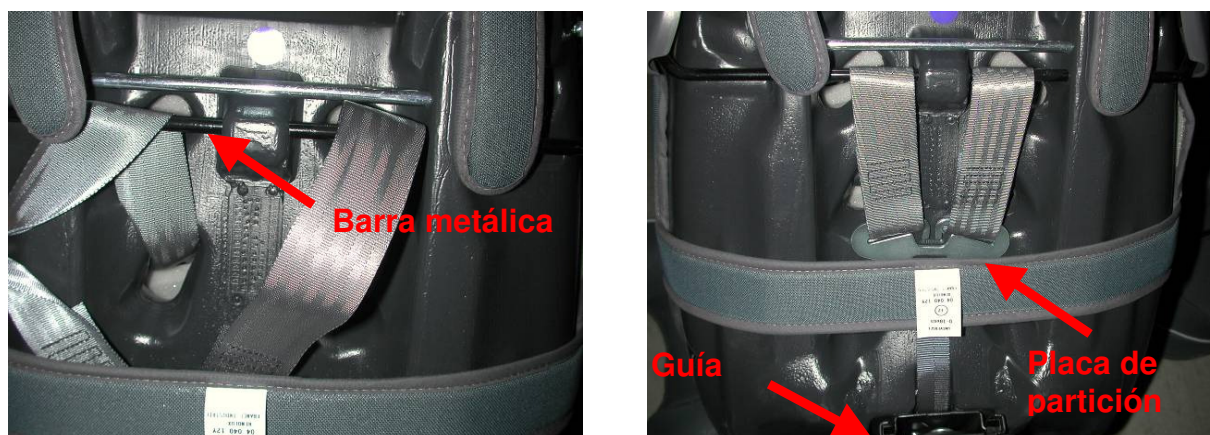
Figure 1: Guiado del arnés integral del Renolux 360°
