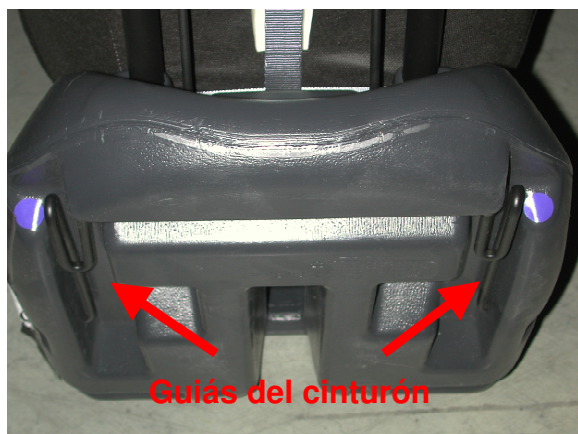
Figura 8: Soporte trasero para el guiado del cinturón en el Renolux Next Confort
