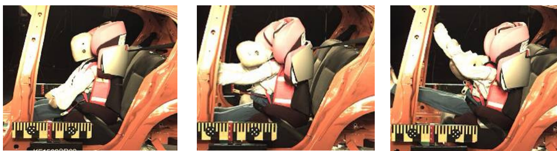
Figura 15: Secuencia del ensayo: “dummy” con mochila escolar en sillita para niños
