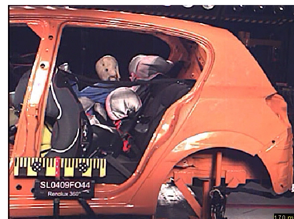
Figura 3: Renolux 360° 97ms (izq.) y 170ms tras el impacto
