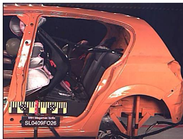
Figura 12: Impacto frontal con IWH Megamax montado de forma incorrecta
