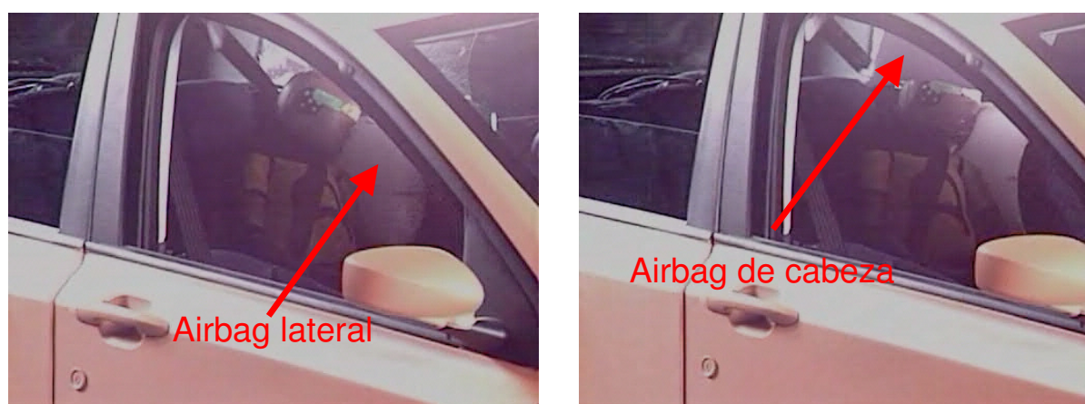
Figura 6: SRI sin respaldo en un ensayo con despliegue del airbag lateral y de cabeza
