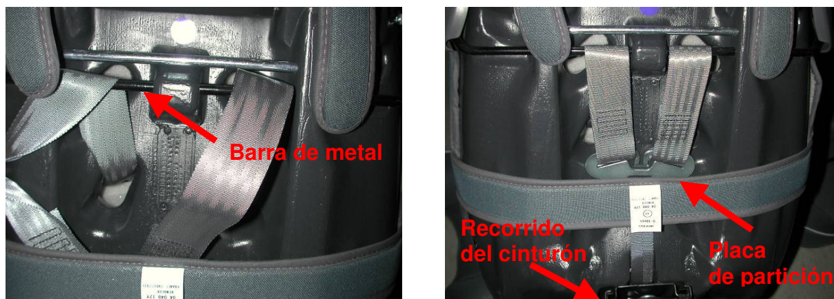
Figura 7: guiado del cinturón en el Renolux 360°
