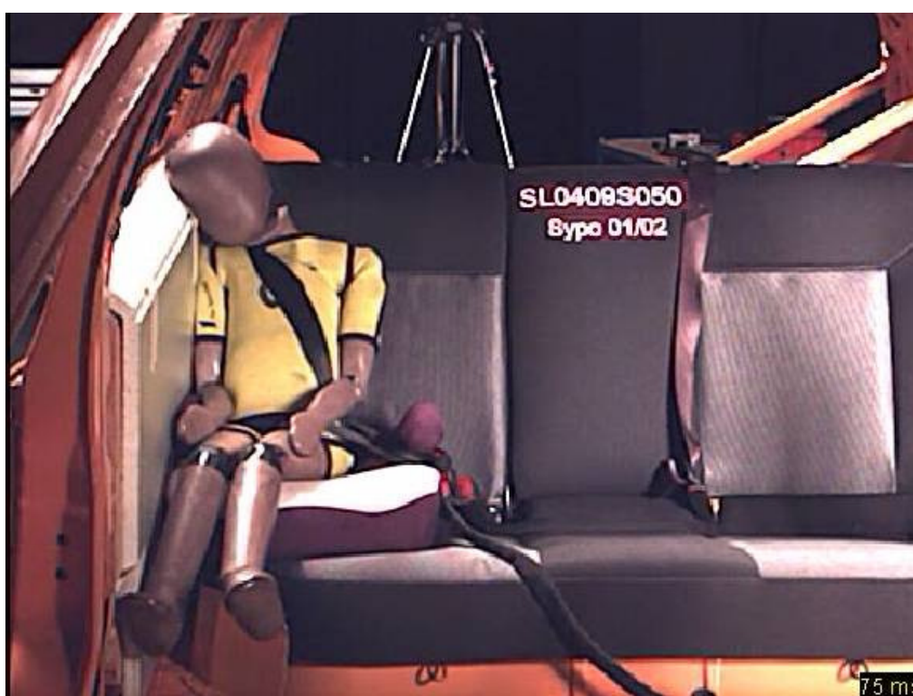
Figura 5: ALPIN Daisy sin respaldo: el pecho y la cabeza del “dummy” están totalmente desprotegidos y golpean fuertemente contra la puerta del coche
