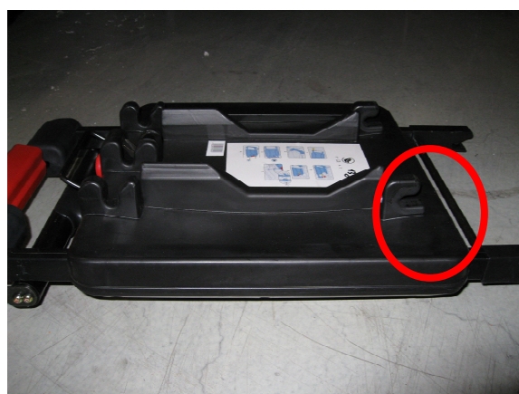
Figura 14: Enganches de montaje en la base del IWH Megamax
