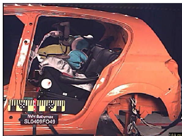
Figura 2: El arnés se suelta de la base del IWH Babymax Isofix
